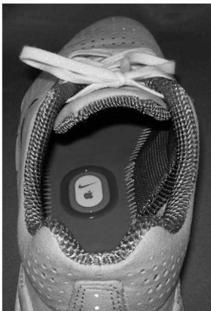
נעל ספורט עם סנסור ברפידה הפנימית. הסנסור מתקשר עם הטלפון הסלולרי של המשמש
